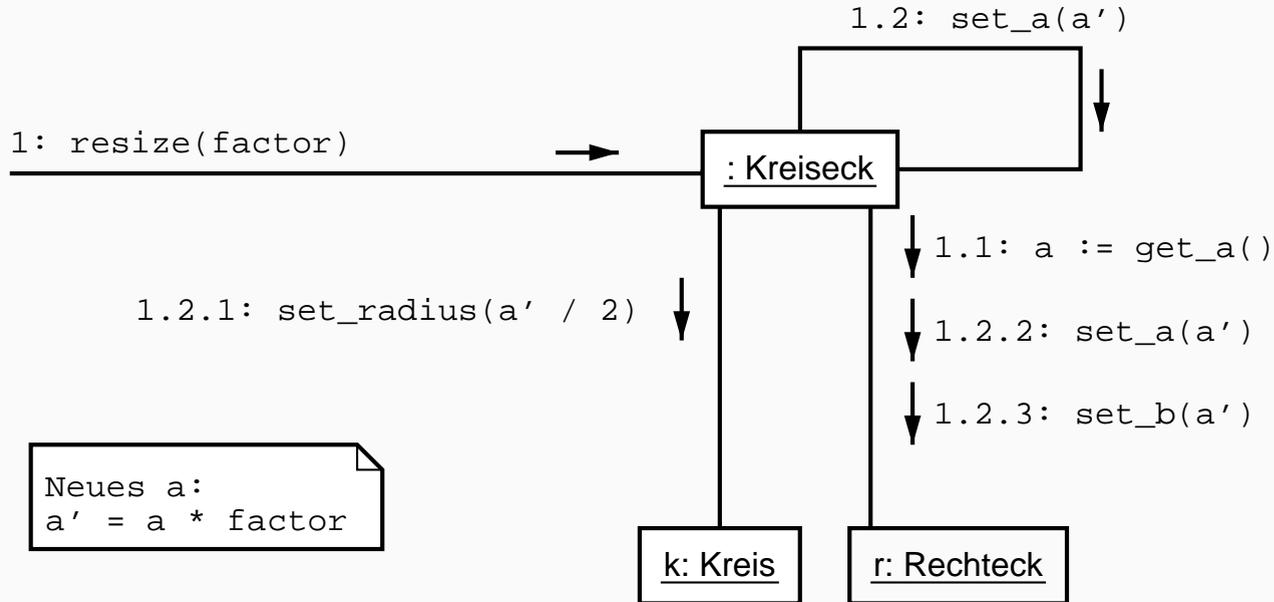
Im Kollaborationsdiagramm werden die Nachrichten *durchnumeriert*.
