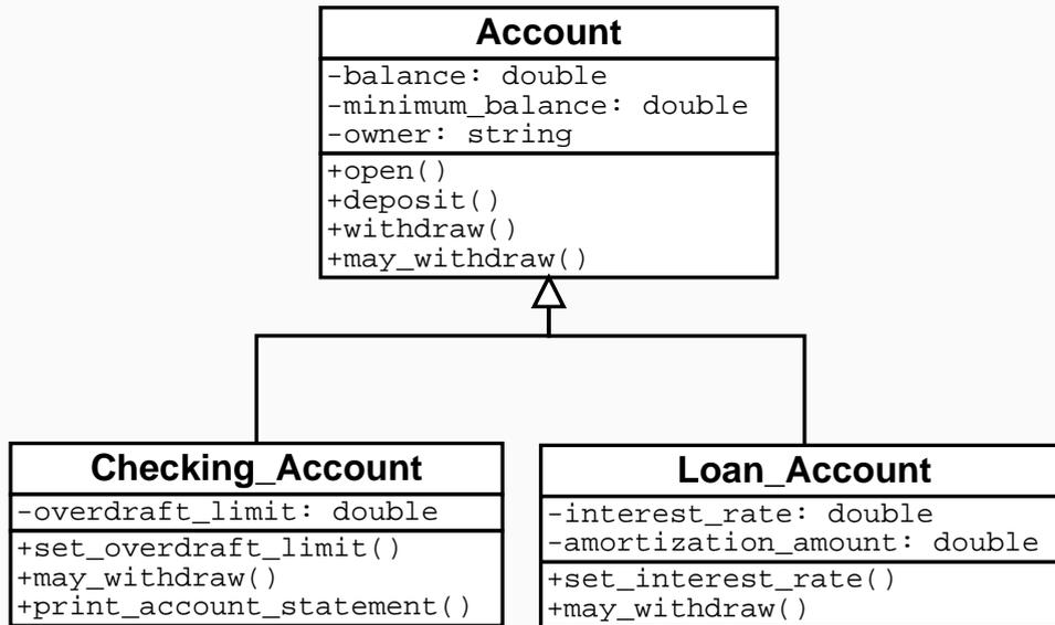
Eerbte Methoden (wie hier: `open()`, `deposit()`) werden in der Unterklasse nicht mehr gesondert aufgeführt.
