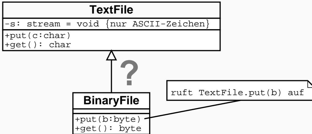
Die Methoden des `BinaryFile` verletzen jedoch die Zusicherung des `TextFile`.
