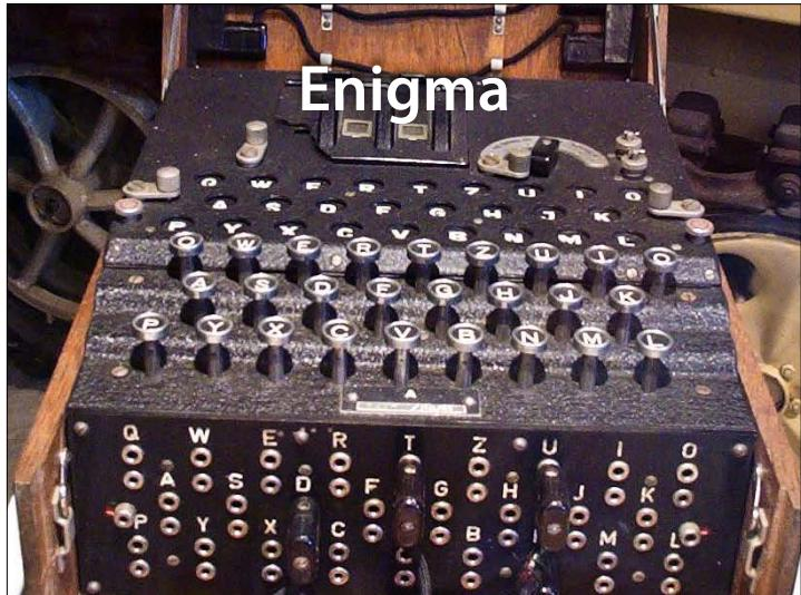
Die ENIGMA (griechisch ἄνιγμα „Rätsel“) ist eine Rotor-Schlüsselmaschine, die im Zweiten Weltkrieg zur Verschlüsselung des Nachrichtenverkehrs des deutschen Militärs verwendet wurde. Trotz mannigfaltiger Verbesserungen der Verschlüsselungsqualität der Maschine vor und während des Krieges, gelang es den Alliierten mit hohem Aufwand zur Entzifferung, die deutschen Funksprüche nahezu kontinuierlich zu brechen. (Wikipedia)
