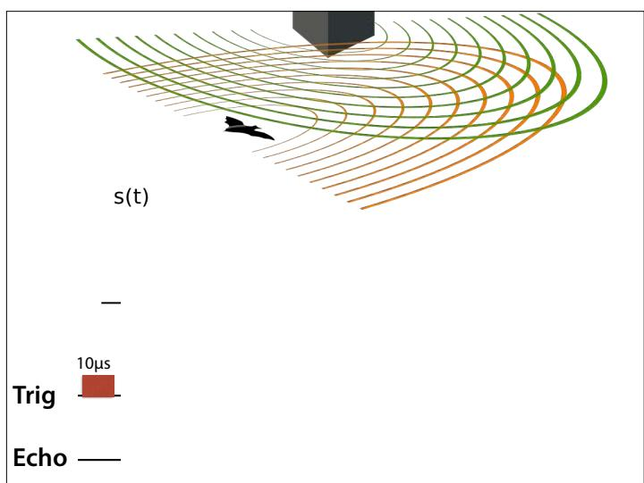
Wir senden zunächst einen Trigger, indem wir **Trig** für 10μs auf **HIGH** setzen
