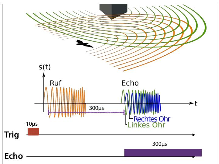
Dann wird das **Echo**-Signal für die Dauer der Signallaufzeit (also hier auch 300µs) auf **HIGH** gesetzt.
