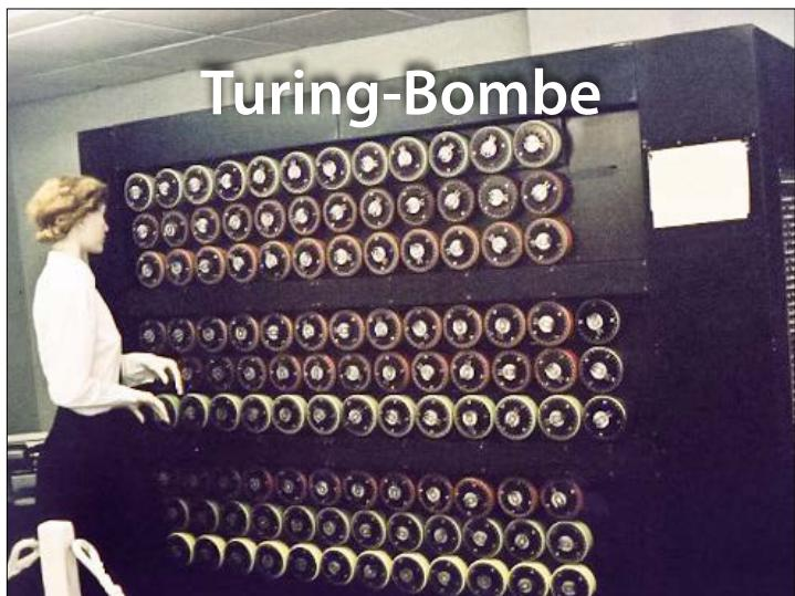
Mit Hilfe der Turing-Bombe (hier ein Nachbau in Bletchley Park, bedient von einer „Wren“) schrumpft der vorher noch so gigantisch erscheinende Schlüsselraum von etwa  $2 \cdot 10^{23}$  Möglichkeiten auf vergleichsweise winzige  $120 \cdot 17.576 = 2.109.120$  (gut zwei Millionen) Möglichkeiten (etwa 21 bit), eine Zahl, die auch bereits zu Zeiten des Zweiten Weltkriegs mithilfe der damaligen elektromechanischen Technik exhaustiv (erschöpfend) abgearbeitet werden konnte. (Wikipedia)
